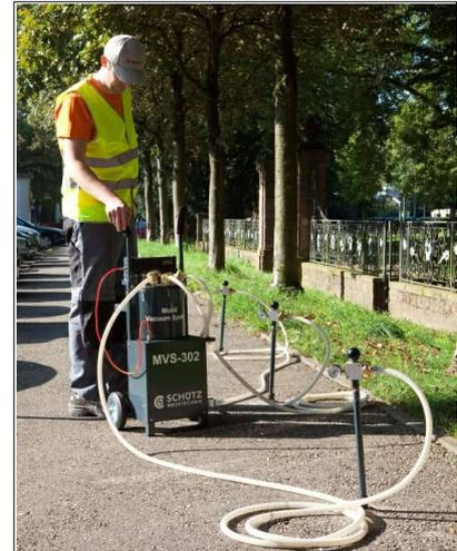
Con la estación de vacío MVS 302 se han obtenido excelentes resultados de comprobación en el sector de redes para gas pesado. Estación de vacío para eliminar bolsas voluminosas de gas halladas en el suelo durante la localización de fugas.
