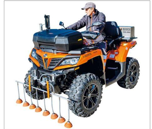
La unidad de medición Scout VGS 4500 es operada y monitoreada con una tableta. El software para esto fue especialmente desarrollado y programado por Schütz GmbH Messtechnik para el sistema. Muestra la ruta tomada en tiempo real, registra y guarda automáticamente cada fuga.
